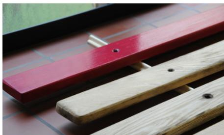
Haben Sie alle Bretter gestrichen, lassen Sie auch die Rückseite 5-6 Stunden trocknen. Reinigen Sie den Pinsel gründlich unter fließendem Wasser.
