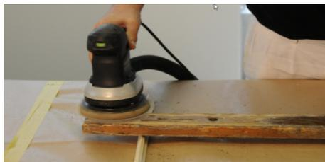
Schleifen Sie die verwitterten und vergraute Holzoberflächen mit einem Exzentrerschleifer (Körnung 150) gleichmäßig und gründlich ab. Das Holz sollte danach wie neu aussehen. Entfernen Sie den Schleifstaub gründlich.
