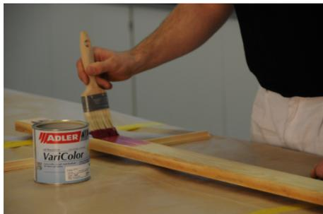
Zuerst lackieren wir die Holzbretter. Um Lacknasen und Tropfen zu verhindern, sollten Sie die einzelnen Teile liegend lackieren. Verwenden Sie einen Wasserlackpinsel und streichen Sie über die Vorderseite und Kanten. Danach müssen Sie die Bretter trocknen lassen, bevor Sie die Rückseite streichen. Der Lack zieht schnell an, deswegen sollten Sie über bereits gestrichene Flächen nicht mehr mit dem Pinsel gehen. Wenn Lacknasen entstehen können Sie diese später mit dem Zwischenschliff ausbessern.
