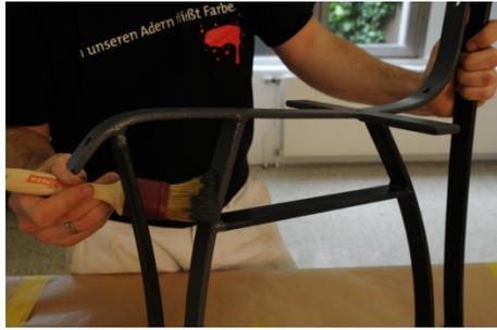
Während das Holz trocknet, können Sie die Metallelemente lackieren. Dafür verwenden wir die Effektbasis ADLER VariColor E20 im Farbton Anthrazit. Mit der E20-Basis ergibt sich der für Metallteile typische Schmiedeeisen-Effekt. Doch der größte Vorteil ist der integrierte Rostschutz.
